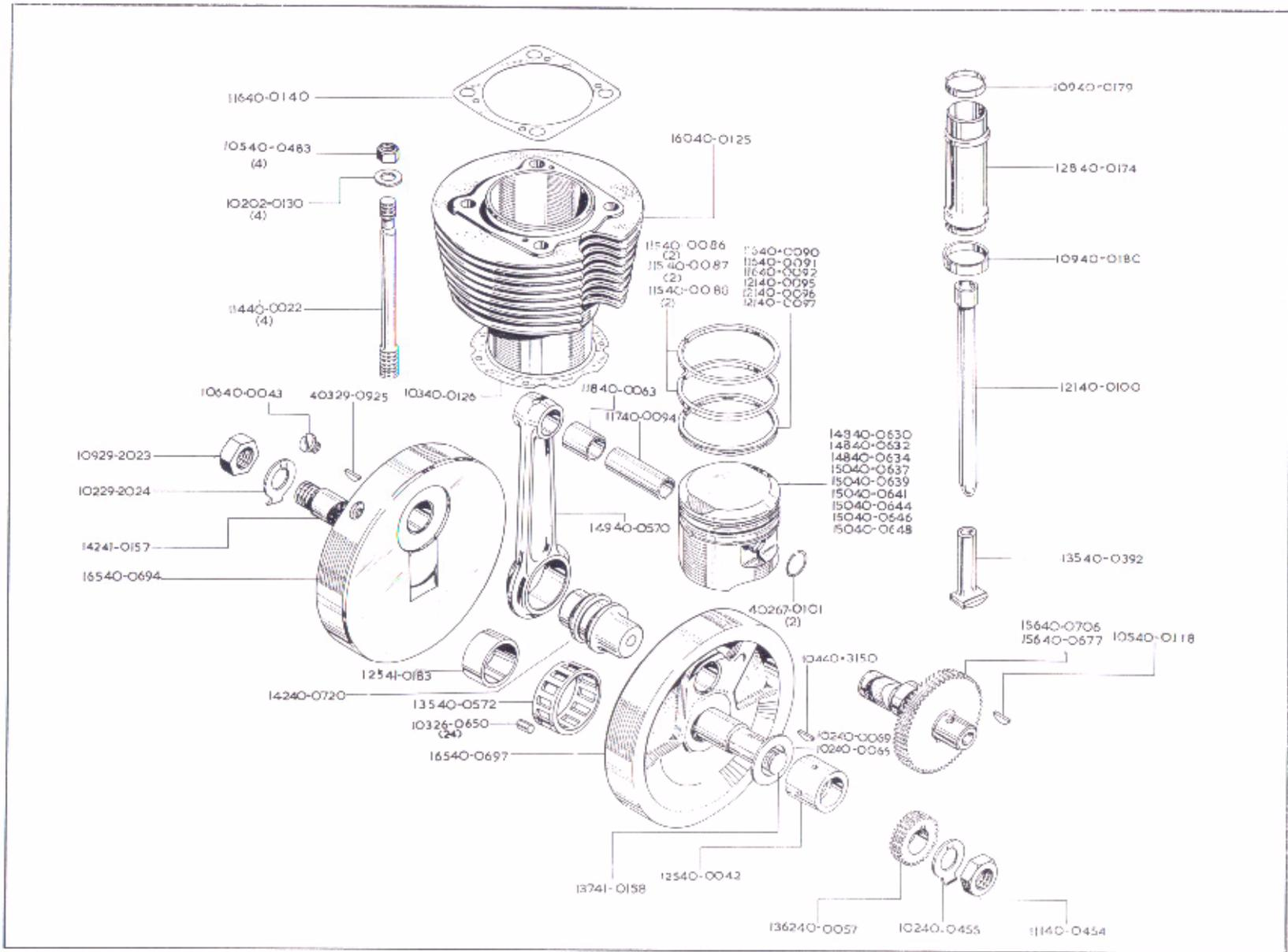
**CYLINDER & CRANKSHAFT, CYLINDRE ET VILEBREQUIN, ZYLINDER UND KURBELWELLE
