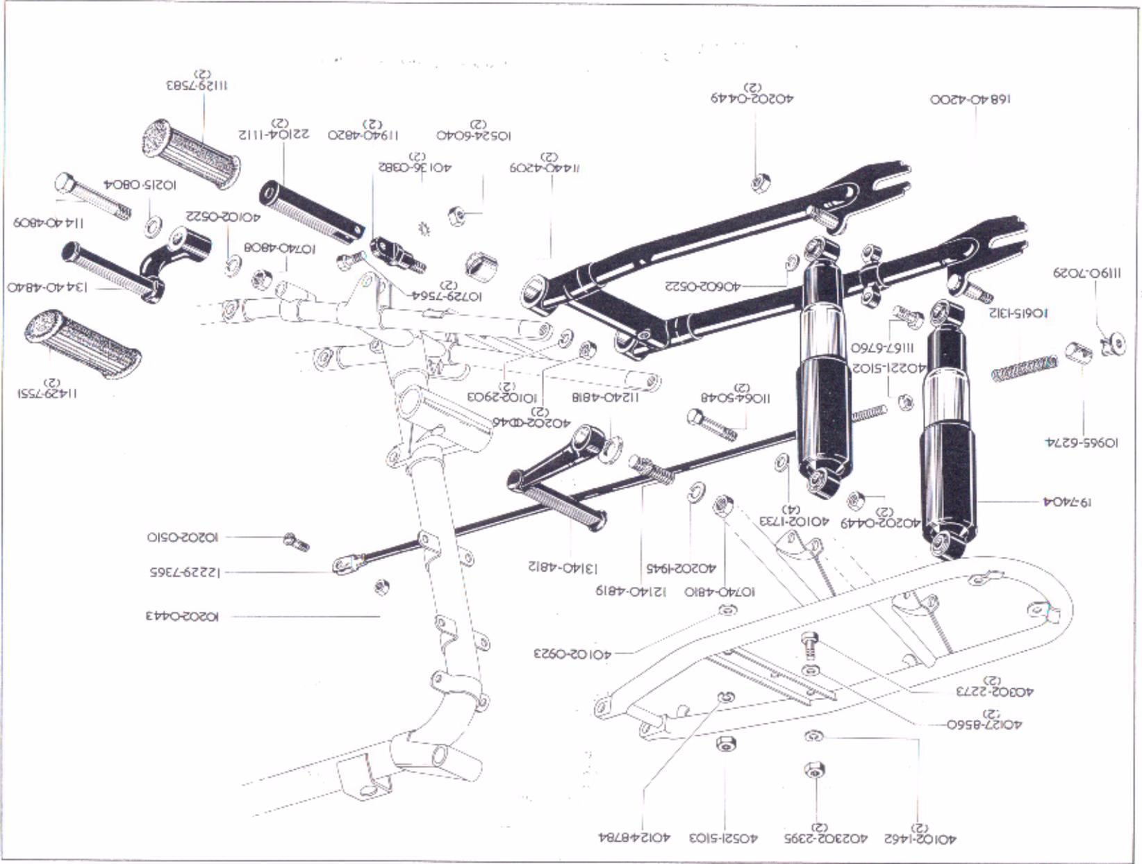
SWINGING ARM, BRAS OSCILLANT, SCHWINGARM, HORQUILLA OSCILANTE
