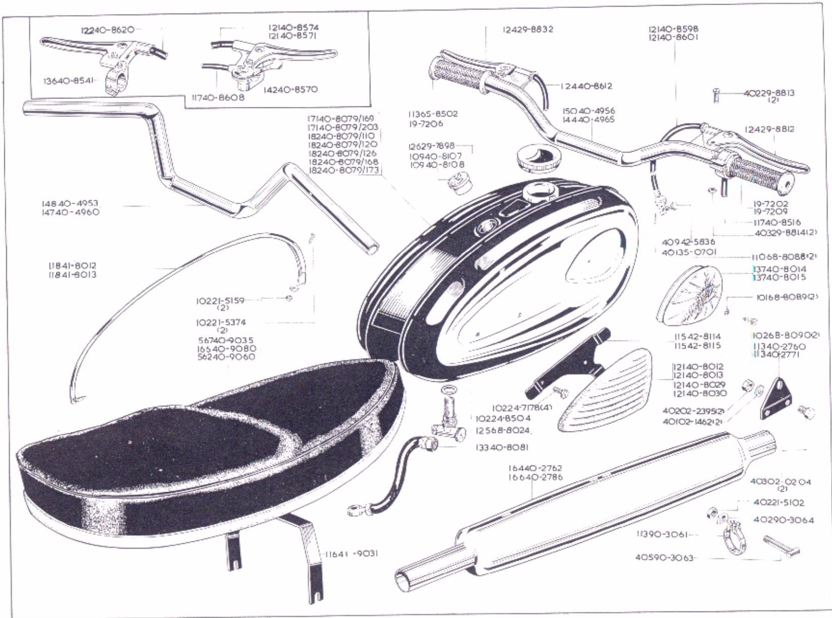
PETROL TANK, RÉSERVOIR D'ESSENCE, BENZINTANK, DEPOSITO DE COMBUSTIBLE
